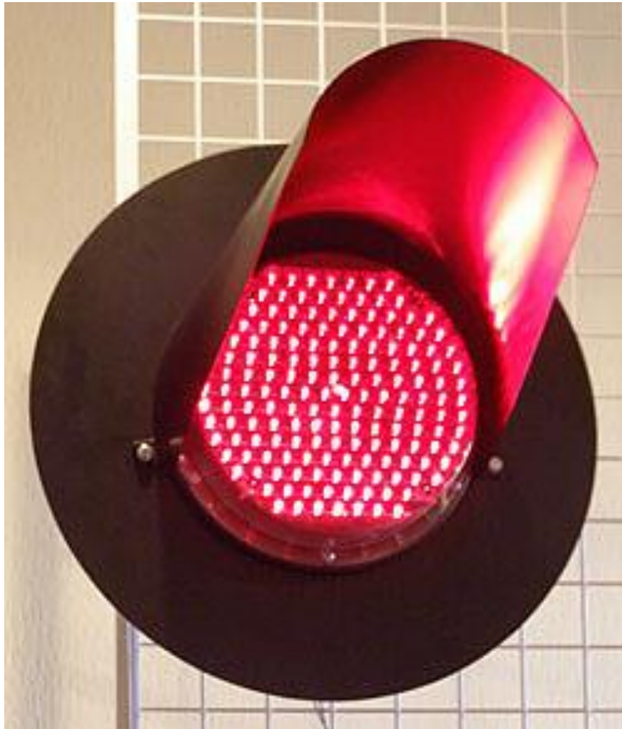
Рисунок 1.1 – Світлодіодна головка світлофора
