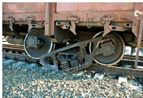
Рис. 1. Триелементний двовісний візок залізничного вантажного вагона типу 18–100 з литими несучими елементами:
