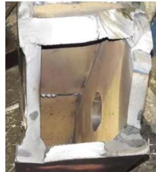
Рис. 13. Руйнування дослідного зразка № 2 суцільнозварної бокової рами після прискорених випробувань на втому:
