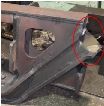
Рис. 13. Руйнування дослідного зразка № 2 суцільнозварної бокової рами після прискорених випробувань на втому:
