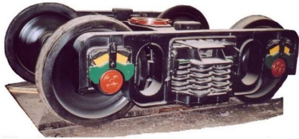
Рис. 5. Конструкції зварних візків вантажного вагона моделей: a – 18-1711 [7, 9, 10]; б – 18-9750
