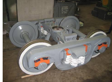
Рис. 5. Конструкції зварних візків вантажного вагона моделей: a – 18-1711 [7, 9, 10]; б – 18-9750
