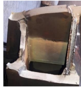
Рис. 12. Руйнування дослідного зразка № 1 суцільнозварної бокової рами після прискорених випробувань на втому:
