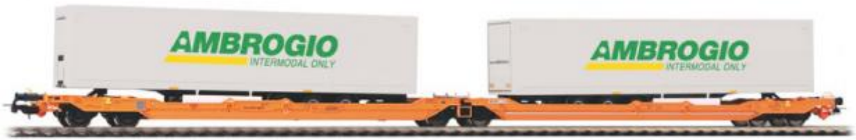
Рисунок 18 – Вагон моделі Т 3000 (megatrailer pocket wagon) [35]
