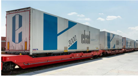
Рисунок 9 – Знімні кузови класу A Long Swap Bodies, встановлені на вагонах-платформах
