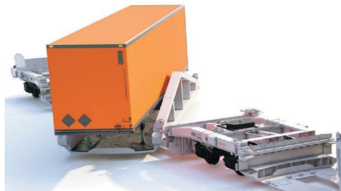
Рисунок 13 – Вагон-платформа з поворотним майданчиком [27]
