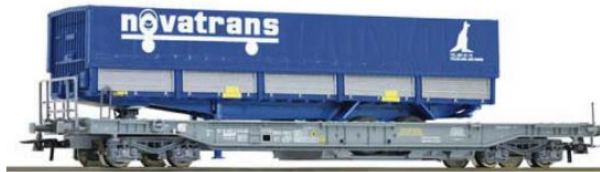
Рисунок 16 – Rocket wagon 1b для перевезення напівпричепів [33]
