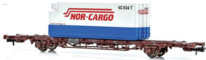
Рисунок 11 – Знімний кузов класу B, встановлений на вагоні-платформі
