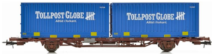
Рисунок 10 – Знімні кузови класу C Short Swap Bodies, встановлені на вагонах-платформах
