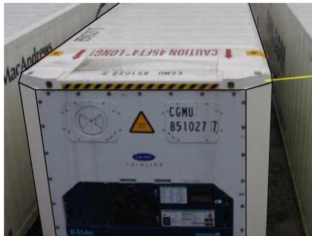
Рисунок 20 – Схема габаритних обмежень, що виникають при транспортуванні європейських ІТО (вгорі) і 45-футова ІТО зі «зрізаними» передніми кутами та спеціальними фітингами (внизу) [52]
