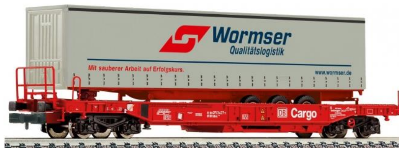
Рисунок 15 – Rocket wagon 1a для перевезення напівпричепів [32]
