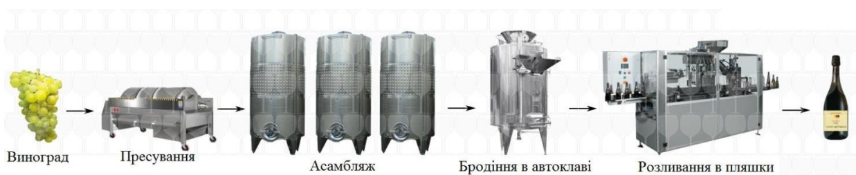
Рисунок 2 – Схема резервуарного методу шампанізації вин
