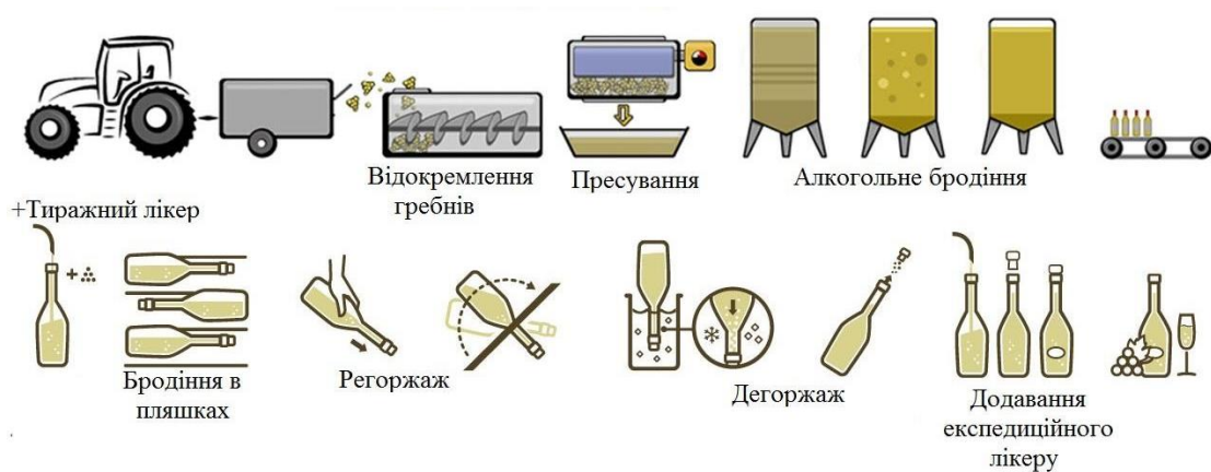
Рисунок 1 – Схема класичного методу шампанізації вин
