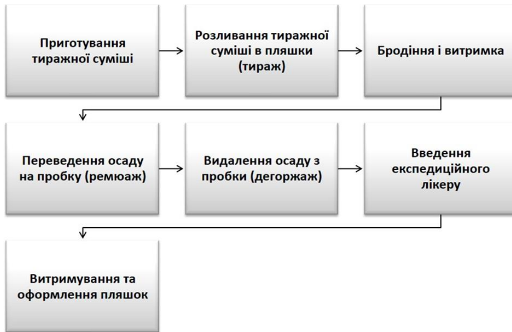
Рисунок 3 – Етапи виробництва ігристих вин
