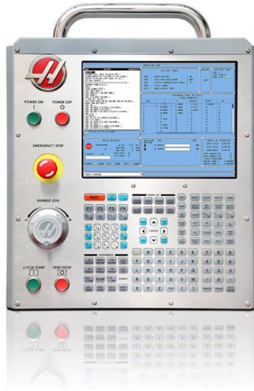
Рисунок 1 – Симулятор пульта керування HAAS
