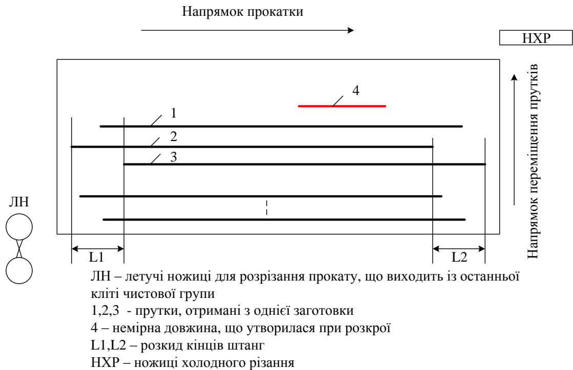
Рисунок 2 – Умовне розташування прутків на холодильнику (вид зверху)
