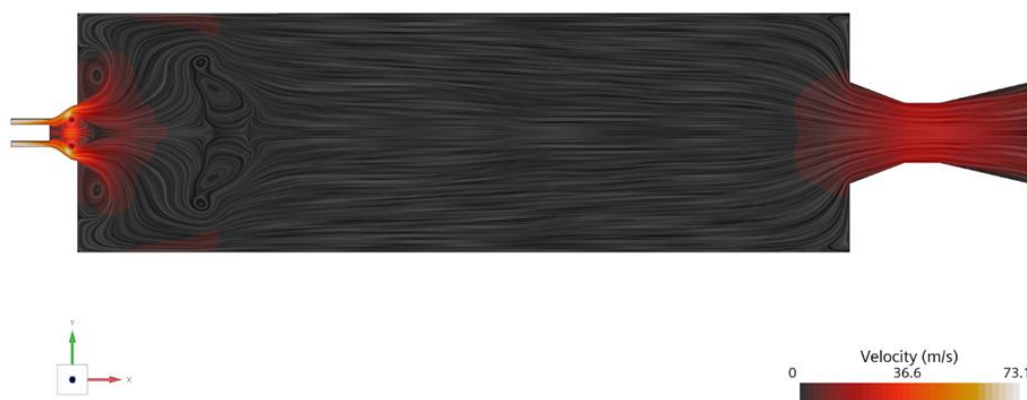
Рисунок 3.3 – Візуалізація поля швидкостей та аеродинаміка газового потоку у реакторі
