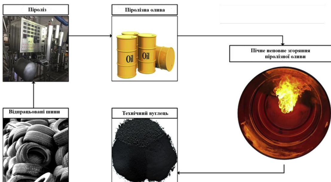
Рисунок 1.1 – Умовна схема переробки відпрацьованих шин для виробництва технічного вуглецю [2]
