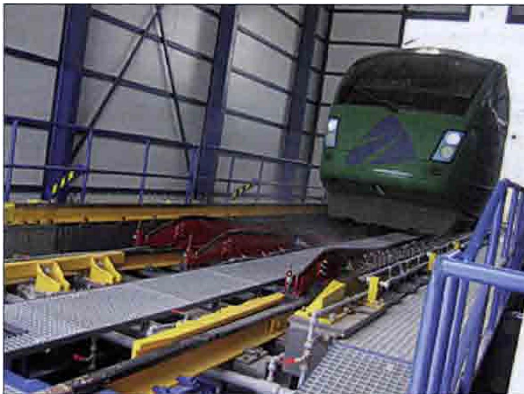
Рисунок 4.9 – Загальний вигляд пристрою для переходу з однієї колії на іншу компанії Talgo в момент пропуску по ньому тепловоза
