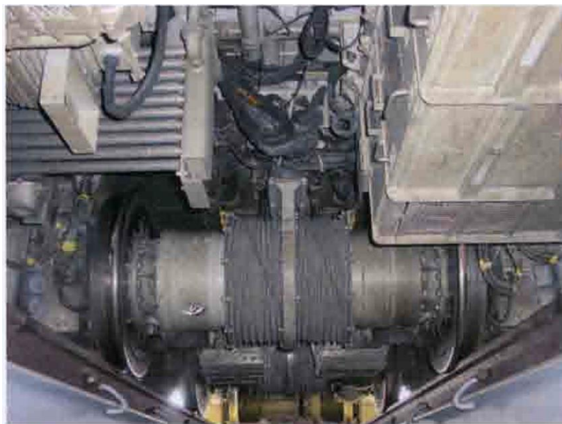
Рисунок 4.12 – Поїзд GCT: візок типу «А» (вид знизу). Японія
