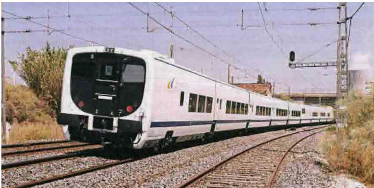
Рисунок 4.4 – Швидкісний поїзд із причіпних вагонів типу Talgo (на передньому плані фото – кінцевий вагон поїзда, що рухається від спостерігача)
