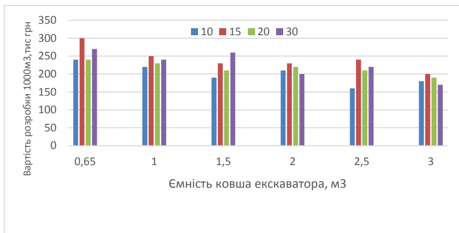
Рис. 3.1 - Зміна вартості розробки ґрунту зі зміною ємності ковша екскаватора і вантажопідйомності автосамоскида при L = 2 км
