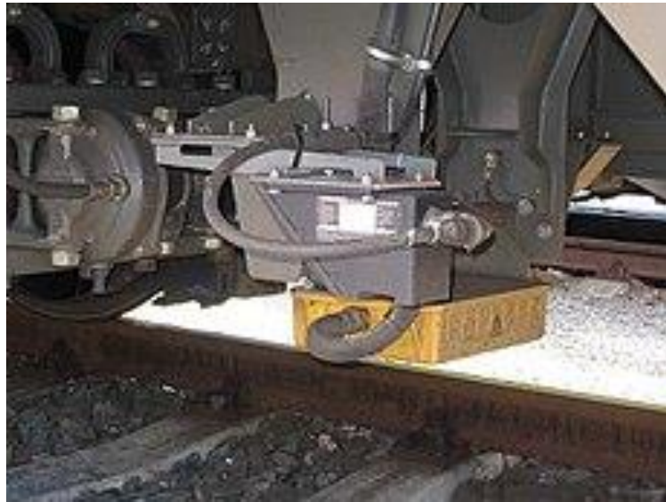
Рисунок 1.4 – Антена для прийому інформації від Евробаліз
