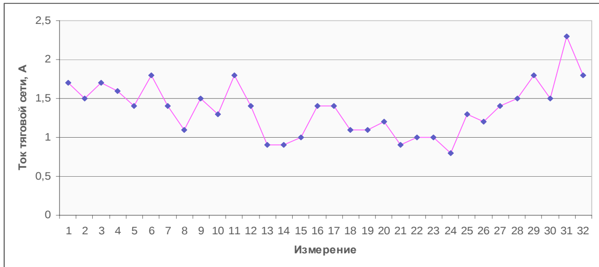
Рис. 5. График изменения амплитуды тока на тяговой подстанции
