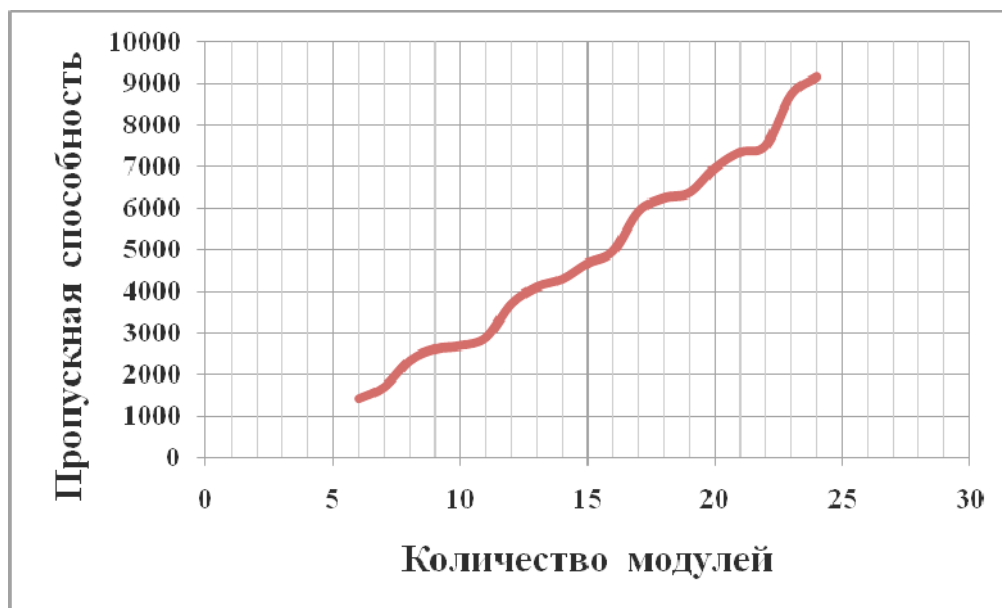
Рис. 1. Зависимость между количеством ремонтных модулей на потоке и его пропускной способностью
