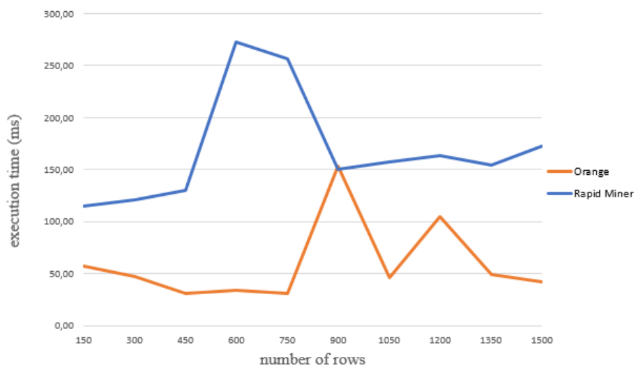
Рисунок 2. Диаграмма зависимости времени выполнения от объема данных на одноядерном процессоре
