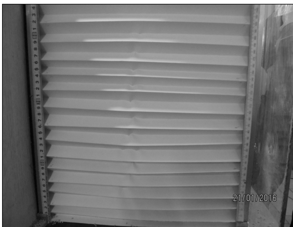
Рис. 5.15. Разрушение панели вследствие потери местной устойчивости пластин гофров по всей высоте
