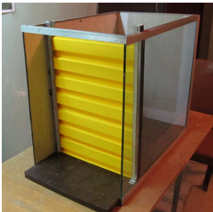
Рис. 5.13. Общий вид экспериментальной емкости с гофрированной стенкой в пазах
