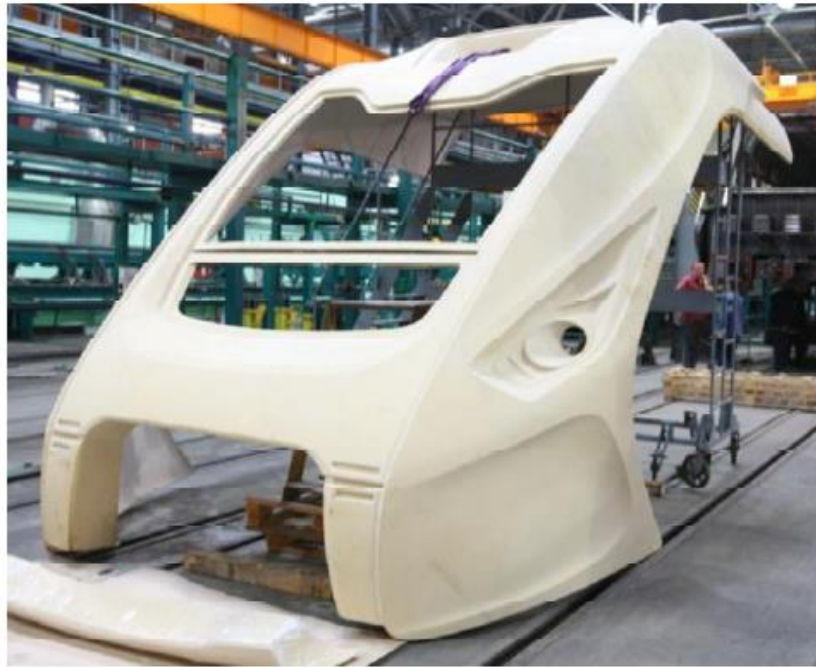
Рисунок 2.7 – Склопластикова маска кабіни машиніста
