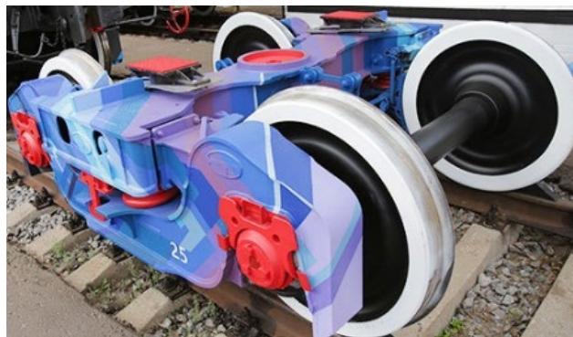
Рисунок 36 – Візок штампозварної конструкції моделі 18-9999
