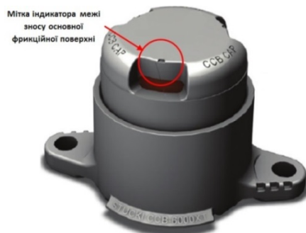
а – ковзун візка ZK1; б – модернізовані ковзуни компанії А. StuckiCompany Рисунок Б.5 – Варіанти виконання міток індикаторів межі зносу основної фрикційної поверхні кришки пружного ковзуна постійного контакту візка вантажного вагона
