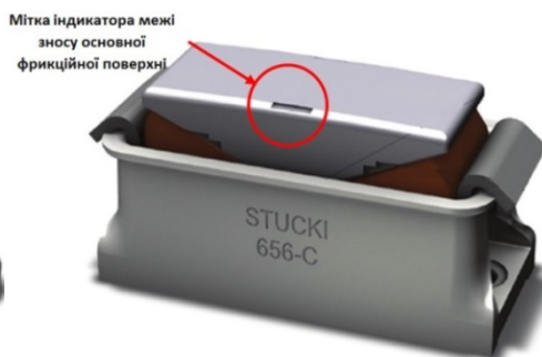
а – ковзун візка ZK1; б – модернізовані ковзуни компанії А. StuckiCompany Рисунок Б.5 – Варіанти виконання міток індикаторів межі зносу основної фрикційної поверхні кришки пружного ковзуна постійного контакту візка вантажного вагона
