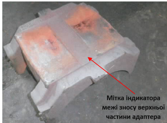
Рисунок Б.6 – Адаптер з індикатором зносу опорної поверхні під бокову раму візків мод. 18-9810, 18-9855 (BARBERS-2-R)
