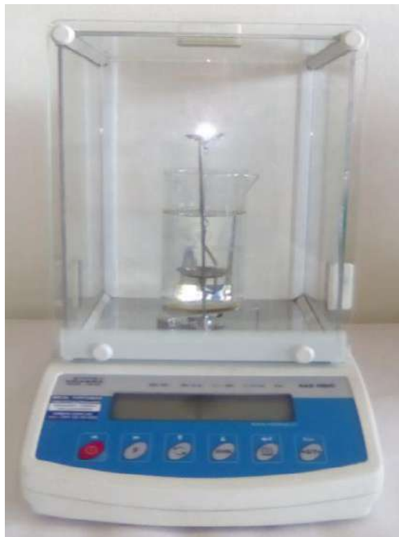
Рисунок 2.16 – Ваги електронні RADWAG XAS 100/C (0,0001г) з пристроєм для гідростатичного зважування
