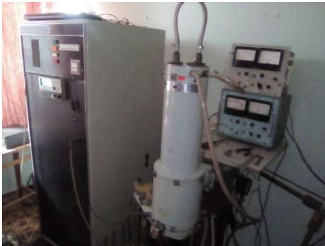
Рисунок 2.14 – Автоматичний дилатометр (а) та система закріплення зразка з прецизійним датчиком переміщення (б)
