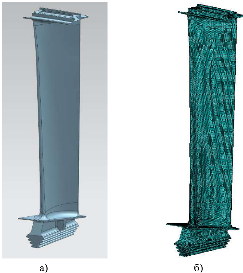
Рисунок 5.4 – Тривимірна (а) та скінченноелементна (б) модель лопатки
