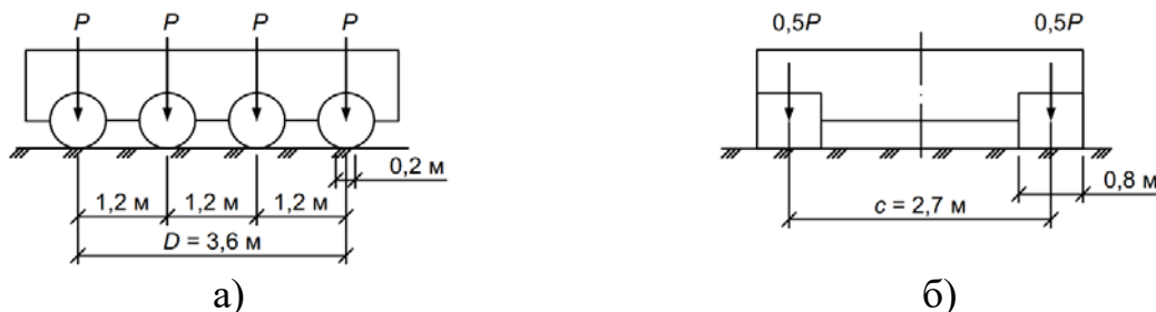
Рисунок 3.4. Поздовжня (а) та поперечна (б) проєкції навантаження НК-100 (навантаження на вісь P = 25 Тс)
