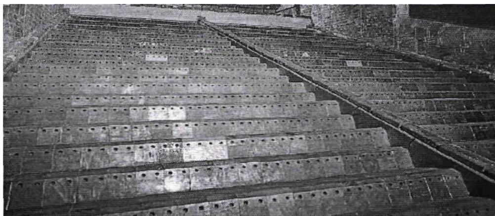
Рисунок 2.2 – Типова колосникова решітка фірми Von Roll
