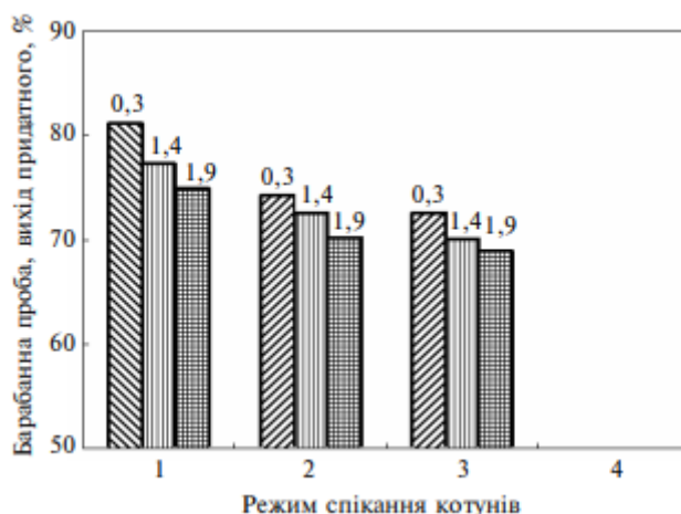
Рис. 2 Результати барабаних проб котунів різної основності, випалених протягом 10 хв: 1 — 1593 К; 2 — 1573 К; 3 — 1553 К
