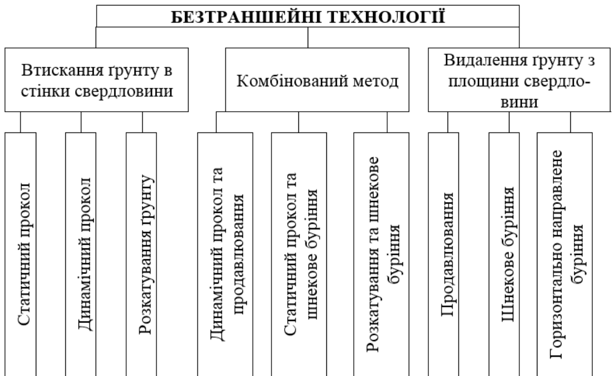
Рис. 1.1. Класифікація безтраншейних технологій прокладки підземних комунікацій
