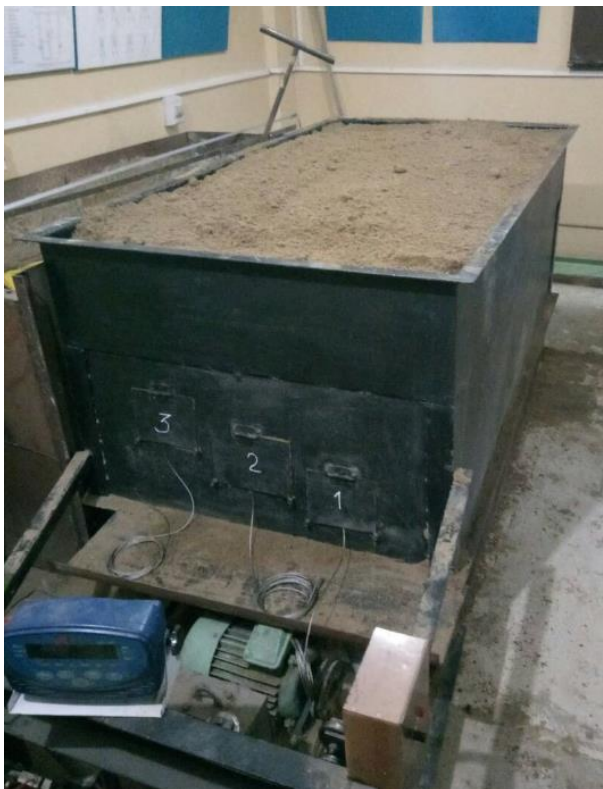
Рис. 5.1. Фото станду: 1 – короб; 2 – редуктор; 3 – електродвигун; 4 – ролики; 5 – приводні канати
