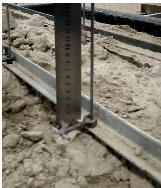
Рис. 5.8. Кутник з фіксаторами для вимірювання деформацій ґрунту
