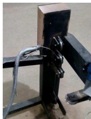
Рис. 5.4. Механізм приводу подачі, та відхиляючі ролики
