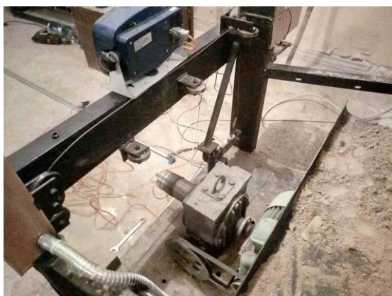
Рис. 5.4. Механізм приводу подачі, та відхиляючі ролики
