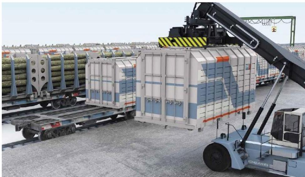
Рисунок 1.9 – Перегрузка съемного кузова
