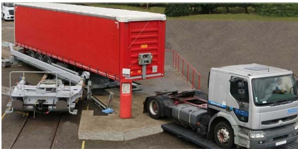
Рисунок 1.8 – Вагон с поворотной платформой
