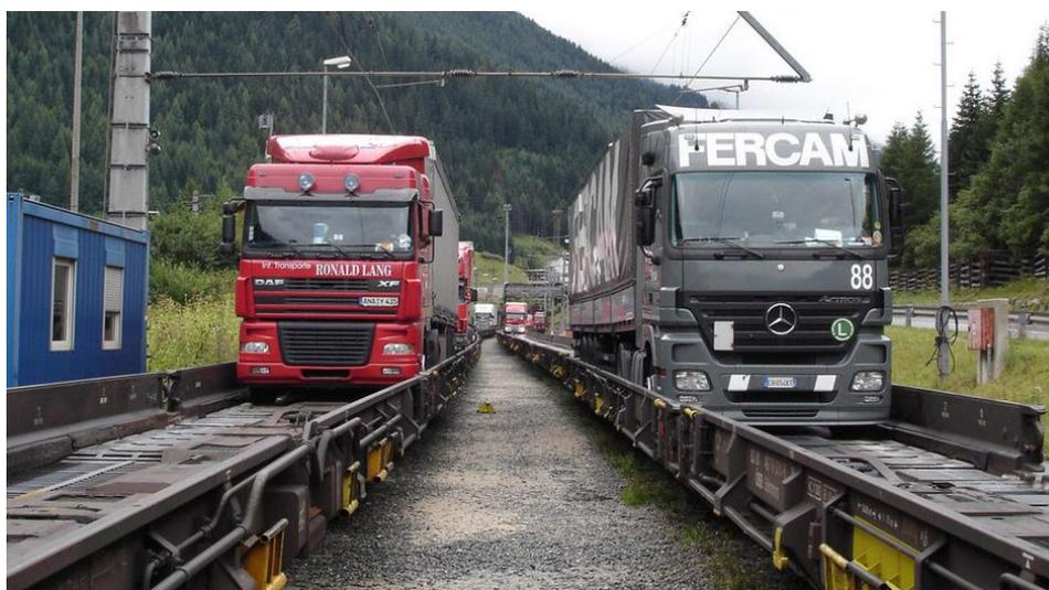
Рисунок 1.7 – Горизонтальная погрузка контрейлерного поезда
