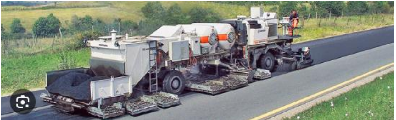
Рисунок 3.2 – Ресайклінг з виготовленням регенованих гарячих асфальтобетонних сумішей змішуванням на дорозі
