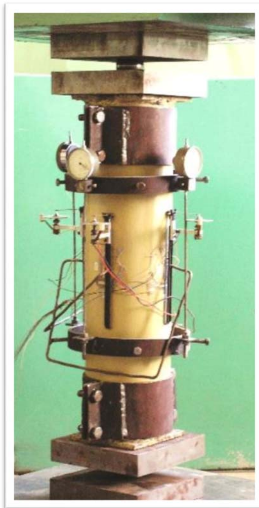
Рисунок 1.2 – Дослідження трубобетонного елемента під час випробувань
