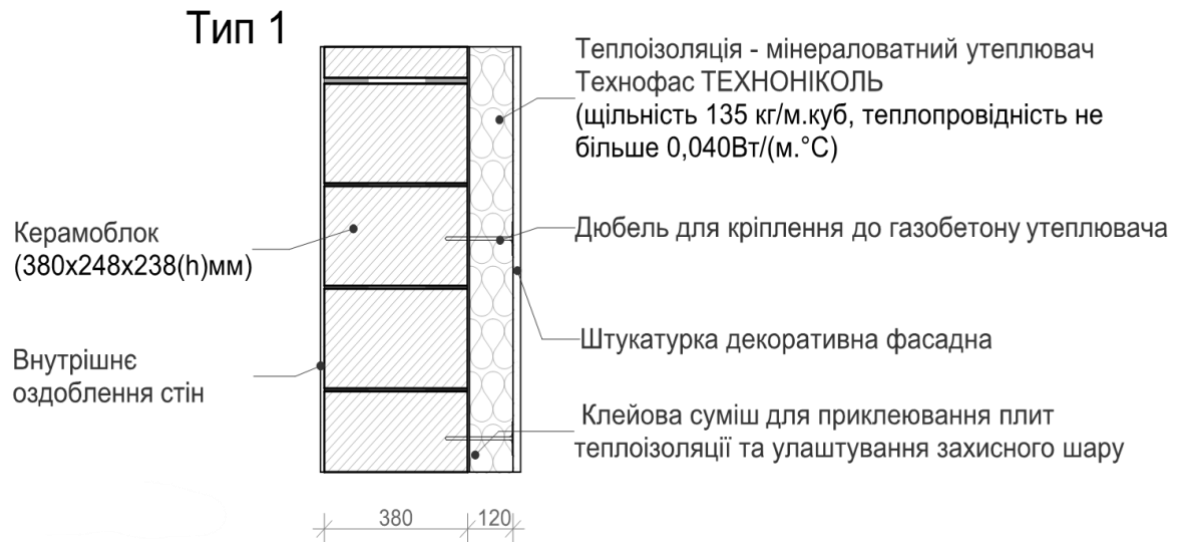
Рисунок 1.4 - Конструкція стіни (тип. 1) будівля
