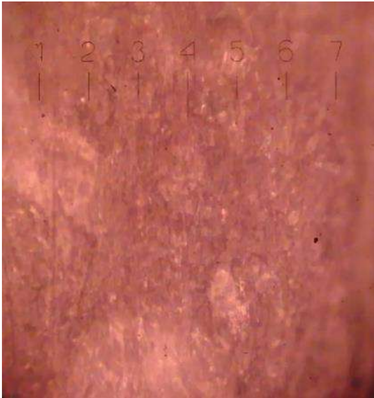
Рисунок 3.7 – Мікроскопічне зображення ДПК із вмістом стеаринової кислоти 1,75 мас. % (ціна поділки 0,3 мкм)
