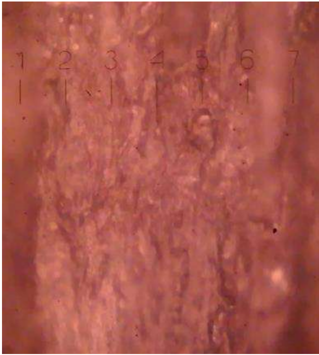
Рисунок 3.31 – Мікроскопічне зображення ДПК із вмістом 5,5 мас. % кальциту та 5,5 мас % фосфогіпсу (ціна поділки 0,3 мкм)
