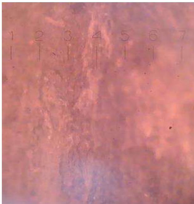
Рисунок 3.30 – Мікроскопічне зображення ДПК із вмістом 8,25 мас. % кальциту та 2,75 мас % фосфогіпсу (ціна поділки 0,3 мкм)
