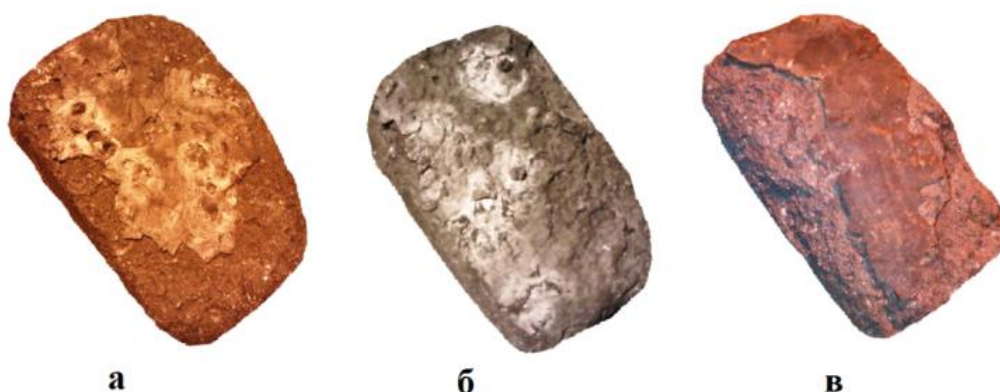
Рисунок 4.6. – Залишковий гарнісажний шар на поверхні вогнетривів після «миття» киснем перед виведенням конвертера, де а) – нижній конус (цапфи) 10-12 мм, б) – завалка 5-10 мм, в) – верхній конус 5-10 мм
