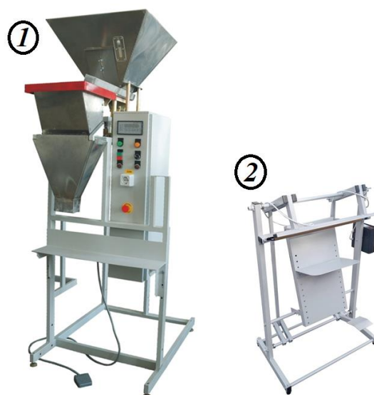
Рисунок 4.14. – Напівавтоматична фасувальна установка (1), запайник поліетиленових пакетів (2).
