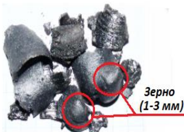
Рисунок 3.20 – Зразок шлаку, що модифіковано складом «БК-4».
