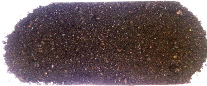
Рисунок 2.18. – Наважка магнезійної ремонтної маси марки «GIR-RB-X» 0,5 кг - експериментальний зразок.
