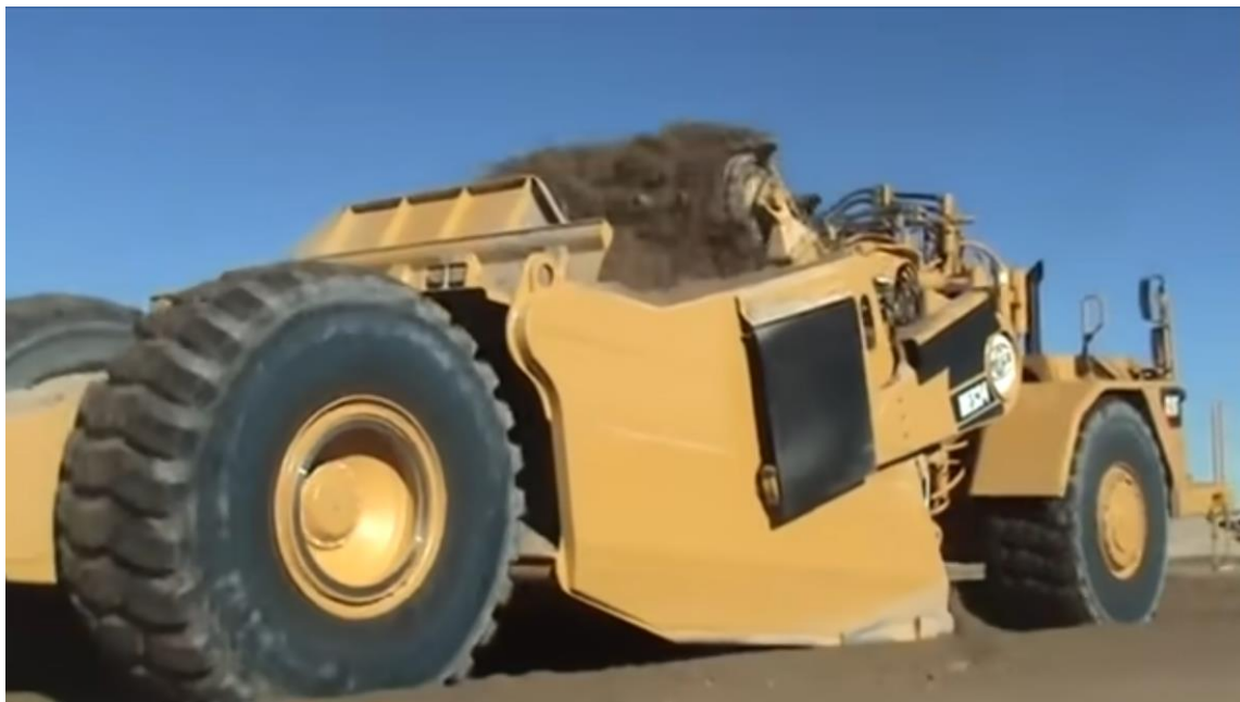
Рис. 1.10. Скрепер під час копання ґрунту
