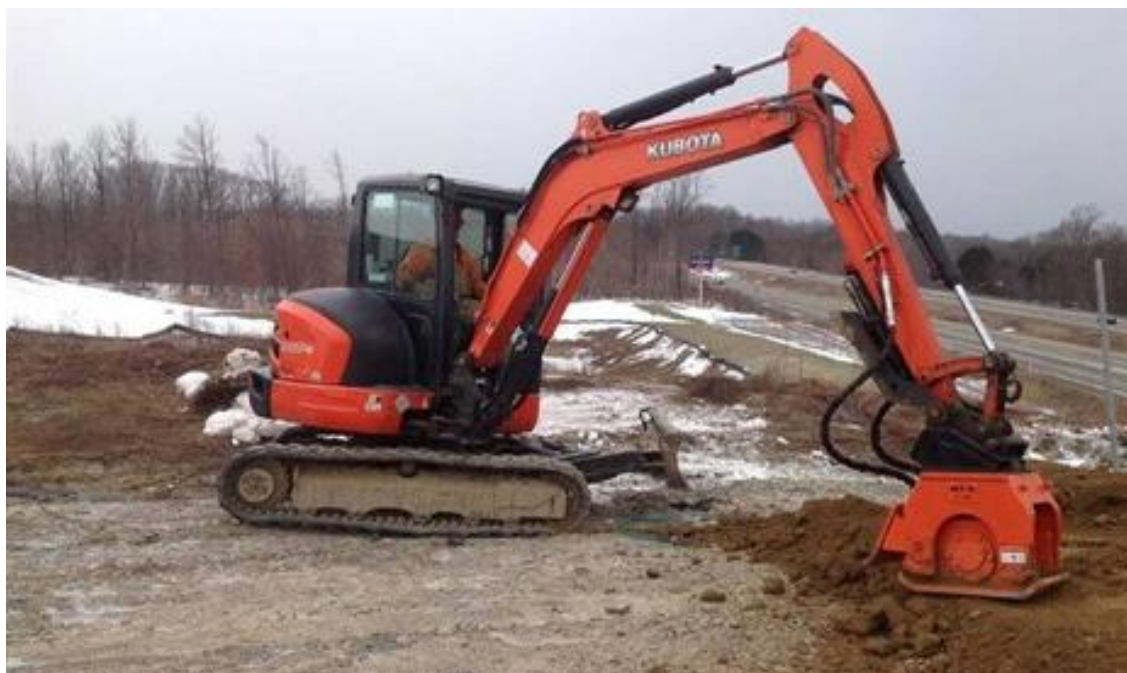
Рис. 1.4. Екскаватор, обладнаний віброплитою
