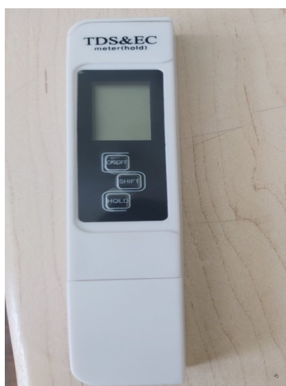
Рисунок 6.4. Прилад TDS&ECmeter (hold) яким вимірювалась концентрація
