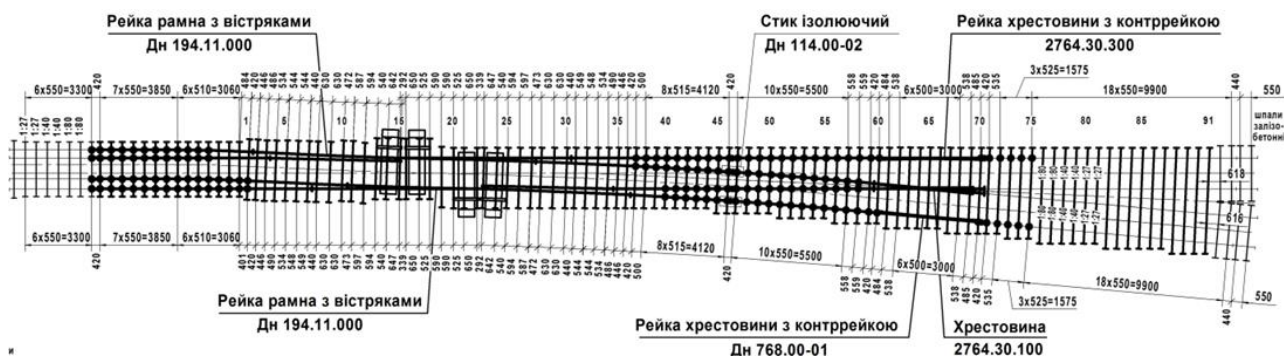
Рисунок 1.7 – Схема вкладання сплетіння типу Р65 марки 1/11 з пересіченням колії 1520 мм колією 1435 мм. Розгалуження вправо
