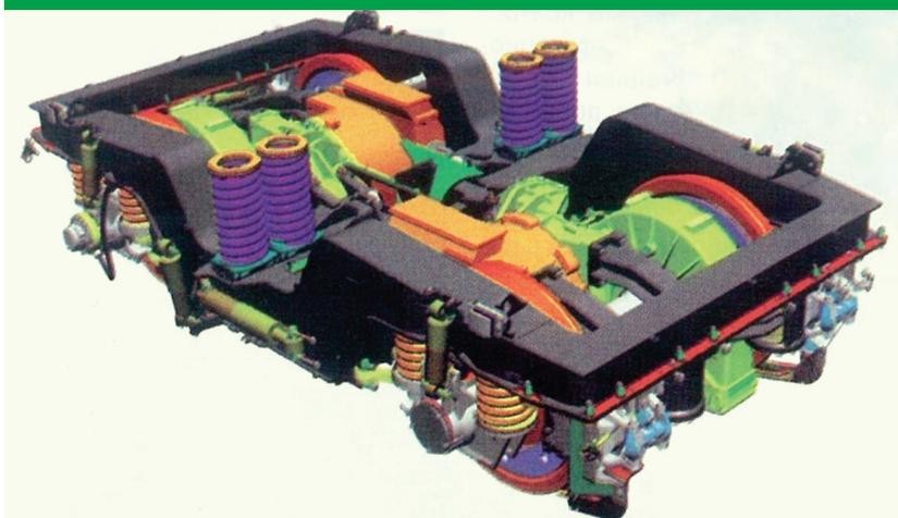
Рис. 8. Модель тележки электровоза ACS64
