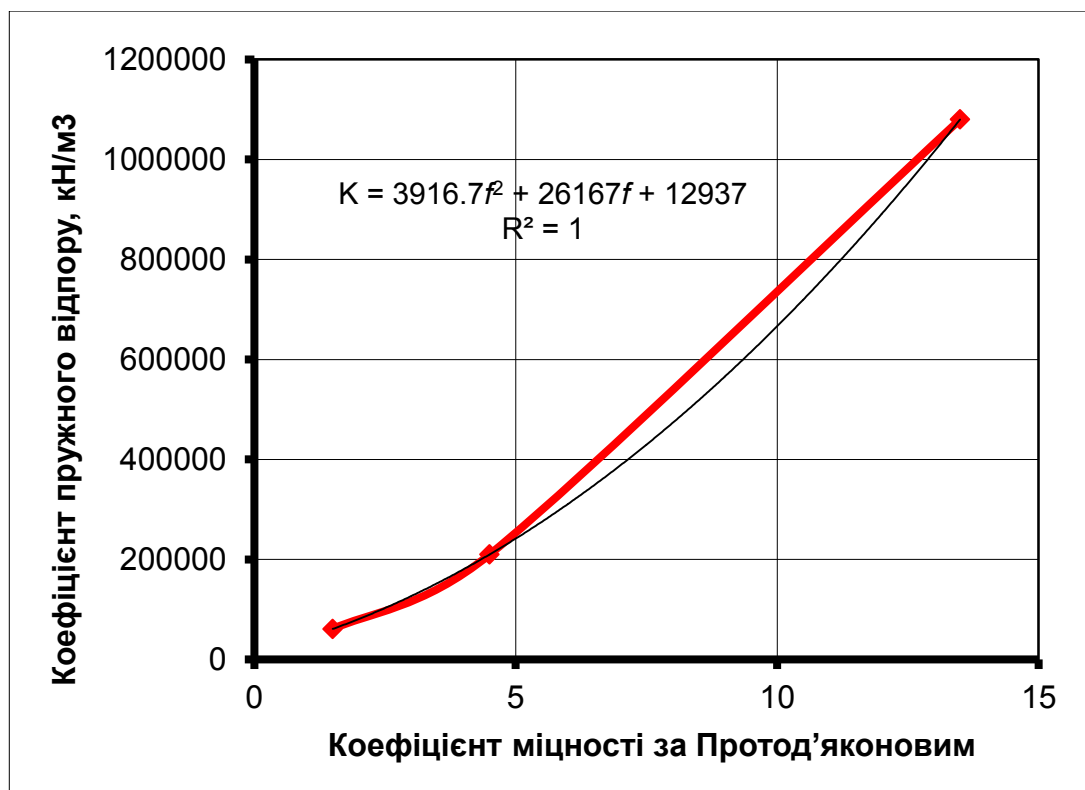
Рисунок 3.36 – Аналітична закономірність коефіцієнту пружного відпору при варіації коефіцієнта міцності за Протод'яконовим
