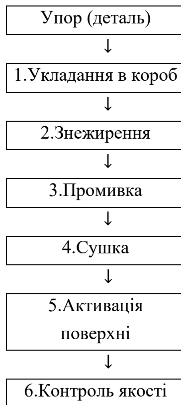
Рисунок 3.3 – Технологічна схема підготовки поверхні деталі
