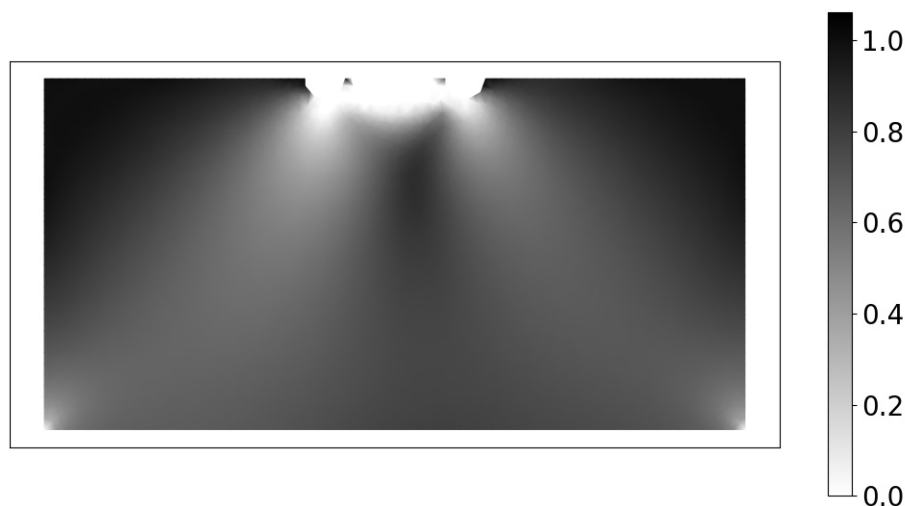
Рисунок 3.3 – Розподіл величини знеміцнення в тілі за наявності симетричних концентраторів напружень
