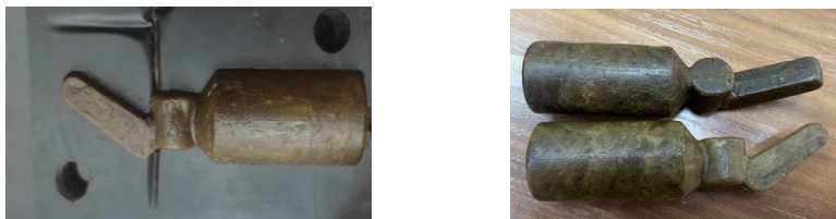
Рисунок 7 – Воскова модель деталі.
