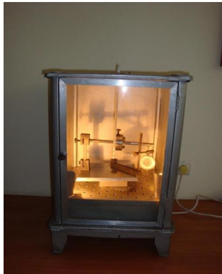
Рис.1.2. Прилад для визначення теплостійкості пластмас за методом Мартенса
