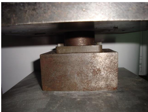
Рис. 2.5. Схема випробування втулки ізолюючої на стиск
