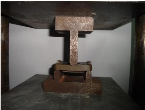
Рис. 2.4. Схема випробування втулки ізолюючої на згин
