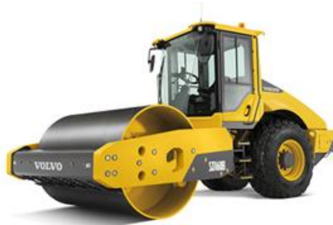
Рисунок 3.3 – Ґрунтовий коток VOLVO SD160B (експлуатаційна маса 17 т)
