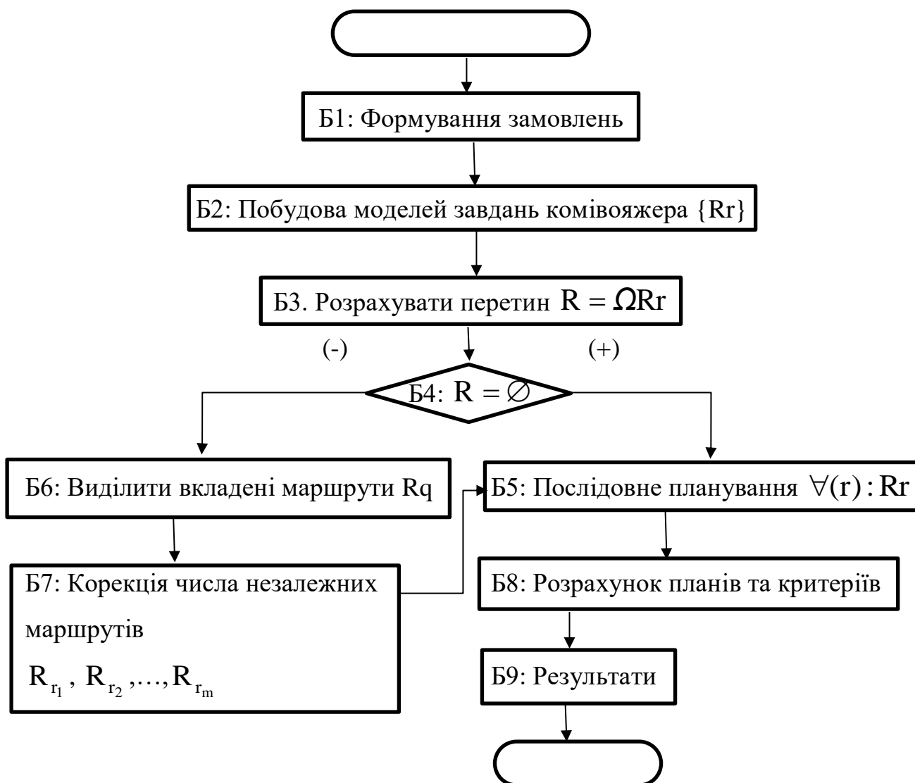
Рис. 2.3. Блок-схема паралельного алгоритму оптимального планування автоперевезень тягачами
