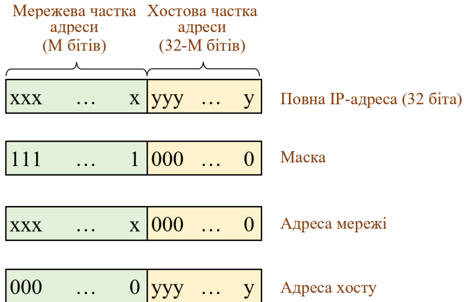
Рисунок 4.1 – Формування адреси мережі та адреси хосту цієї мережі за допомогою маски
