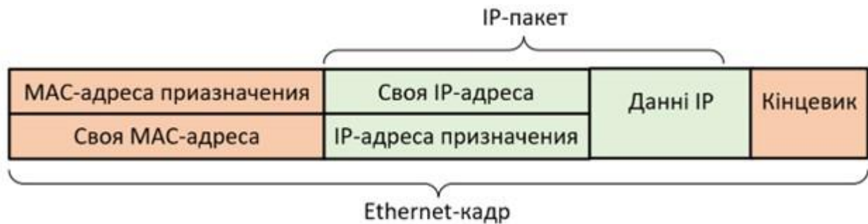
Рисунок 2.1 – Спрощена схема розміщення IP-пакету в кадрі Ethernet
