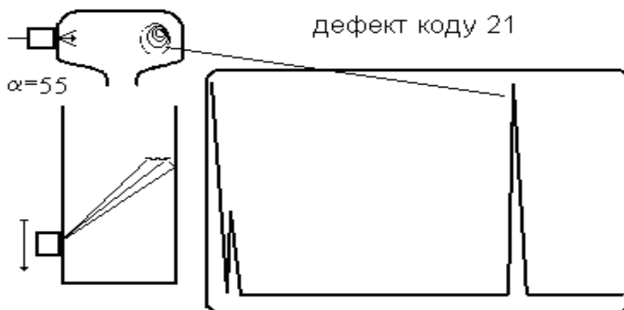
Рисунок 2.3 Код дефекту 21 з 55°
