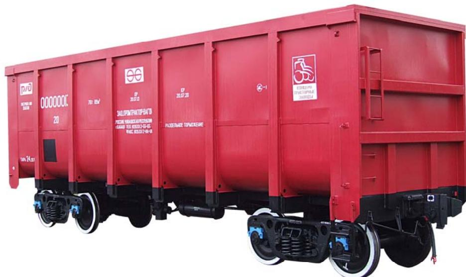
Рисунок 3 - Полувагон габарита Тпр мод. 12-2123
