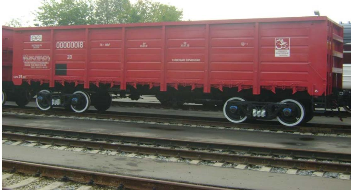
Рисунок 4 - Полувагон универсальний люковый мод. 12-1304
