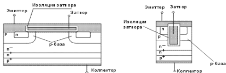
Рис. 1.4 Схематичний розріз структури IGBT
