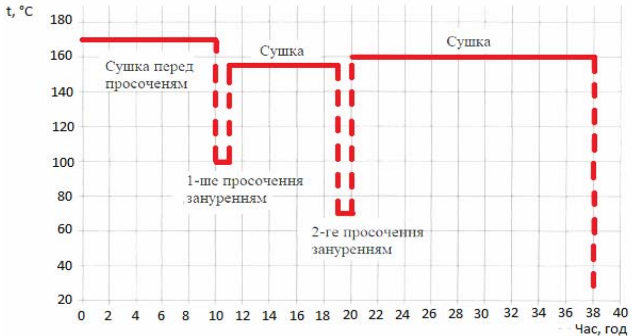
Рисунок. 1.4 – Діаграма сушки, просочення і термообробки вузлів ТЕД, просочених в лаку ФЛ-98
