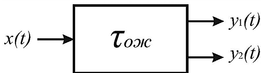
Рисунок 4.10 – Схема функционирования ОМ как кусочно-линейного агрегата
