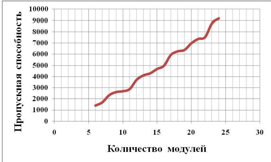
Рисунок 6.2 - График зависимости между количеством ремонтных модулей на потоке и его пропускной способностью
