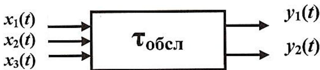
Рисунок 4.11 – Схема функционирования ТМ как кусочно-линейного агрегата
