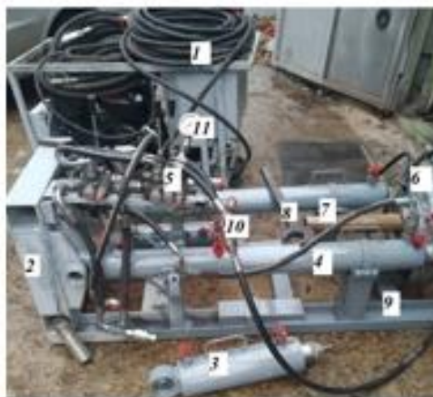
Рис. 1.4. Статичний прокол ґрунту: а) – прокол та розширення ТПГ; б) – Прокол трубою футляром з наконечником; в) – установка МП-250 виробництва НВП «Газтехніка», м. Харків; г) – установка проколу ґрунту УПГ-30, ТОВ «Укріндустріалгруп», м. Дніпро; д) – установки для керованого статичного проколу ґрунту МПК-30-100, ТОВ «МБК Сінергія»
