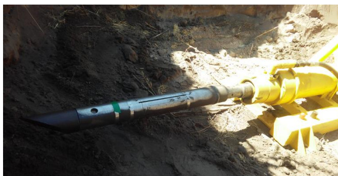
Рис. 3.10. Процес проколу ґрунту експериментальною установкою з можливістю керування траєкторією руху головки в підземному просторі
