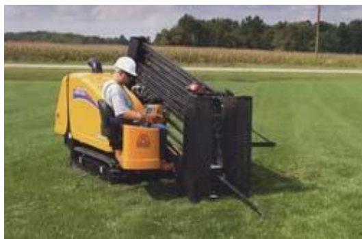
Рис. 1.9. Компактна установка горизонтально-направленого бурення ГНБ Astec DD-1215
