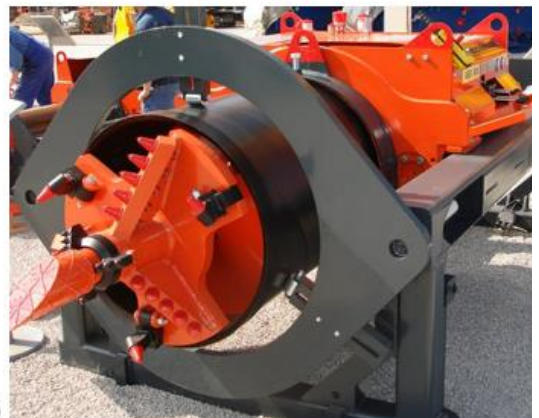
Рис. 1.7. Установки шнекового буріння: а) – розбурювання пілотного отвору – пресова бурова установка Perforator PVA-150 ; б) – розташування шнеку та ґрунту в момент пілотного розбурювання; в) – робота машини в напрямку з встановленою секцією труби, яка прокладається – пресова бурова установка Perforator PVA-200; г) – бурошнекова установка ABS-800 (Auger Boring Systems) (Германия)
