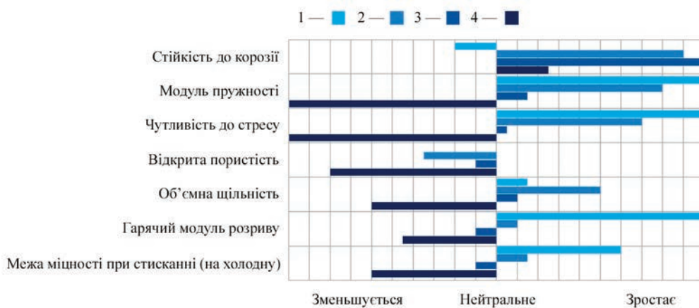
Рис. 1. Діаграма залежності властивостей MgO–C цегли від модифікацій: 1 — антиоксиданти; 2 — плавлена магнезія; 3 — сорт MgO; 4 — вуглець
