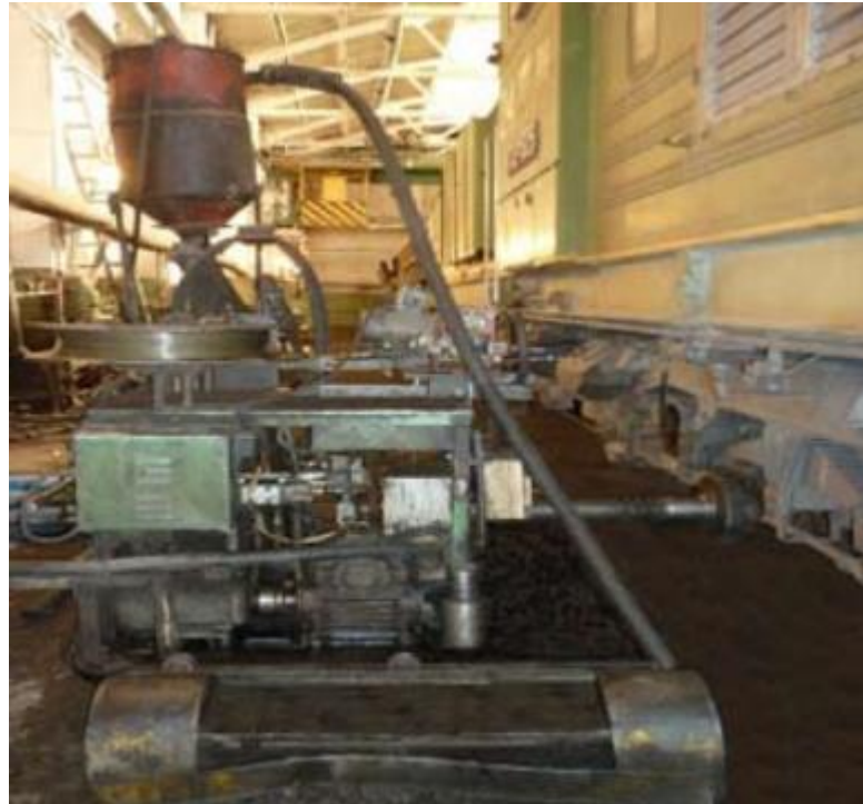
Рисунок 3.2 – Вигляд установки для наплавлення гребенів бандажів без викатки колісних пар з-під електровозу
