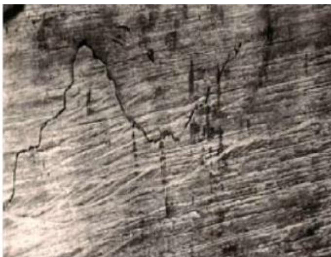
Рисунок 3.3 – Втомні тріщини на робочій поверхні гребеня бандажа
