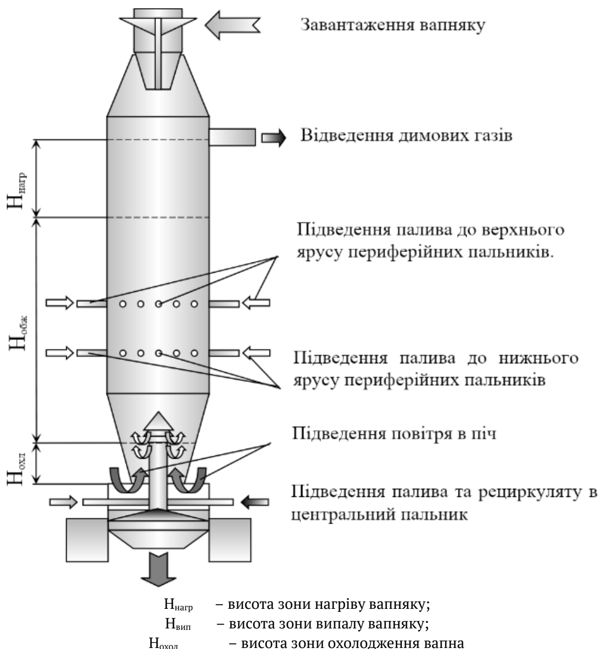
Рисунок 1 - Схема шахтної вапняно-випалювальної печі на газоподібному паливі
