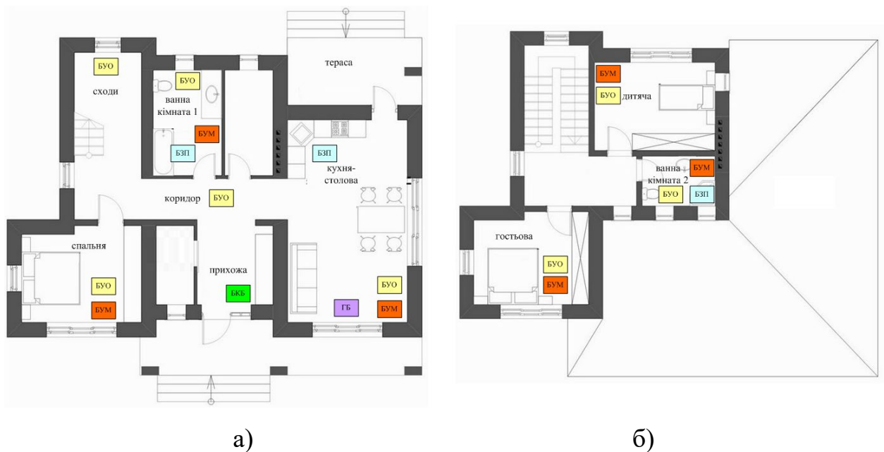
Рисунок 2.2 – План будинку з установленими блоками системи:
