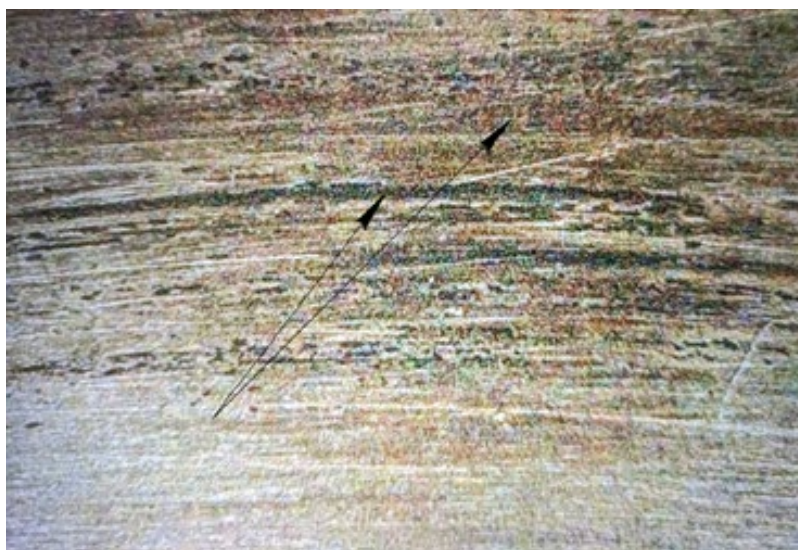
Рисунок 3 - Макроструктура робочої поверхні опори люльки зі слідами контактного зношення (збільшення 1080х)
