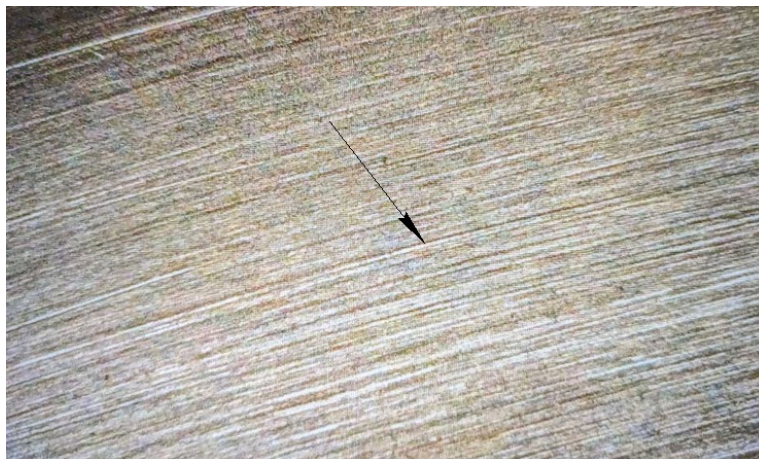
Рисунок 2 – Макроструктура робочої поверхні опори люльки зі слідами гідроабразивного зношення (збільшення 1080х)
