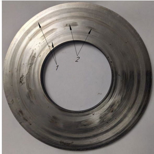
Рисунок 1 - Характерні поверхні зношення опори люльки:
