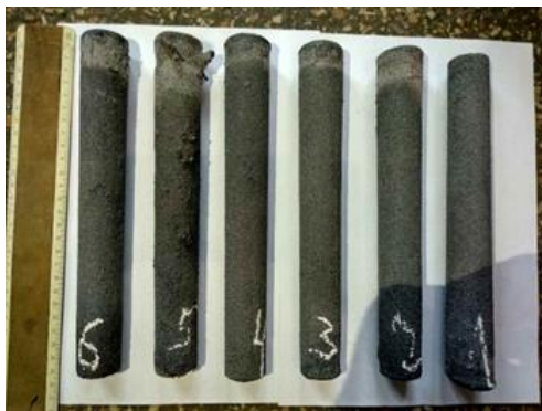
Рисунок 2 – Виливки чавуну після вилучення з форми
