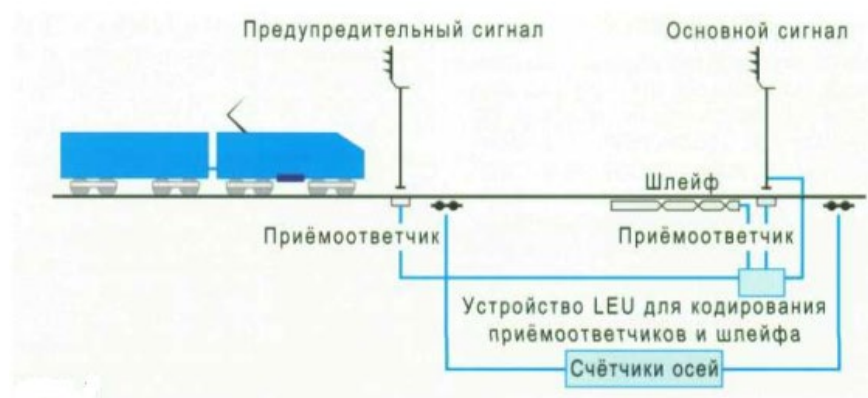
Рисунок 1.22 – Первая ступень оснащения ETCS (LEVEL 1)
