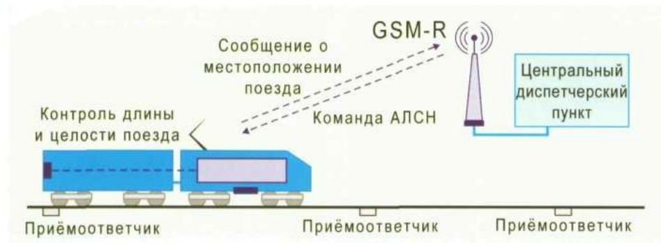
Рисунок 1.24 – Третья ступень оснащения ETCS (LEVEL 3)
