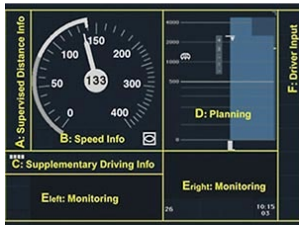
Рисунок 1.25 – Функциональные поля пользовательского интерфейса машиниста DMI
